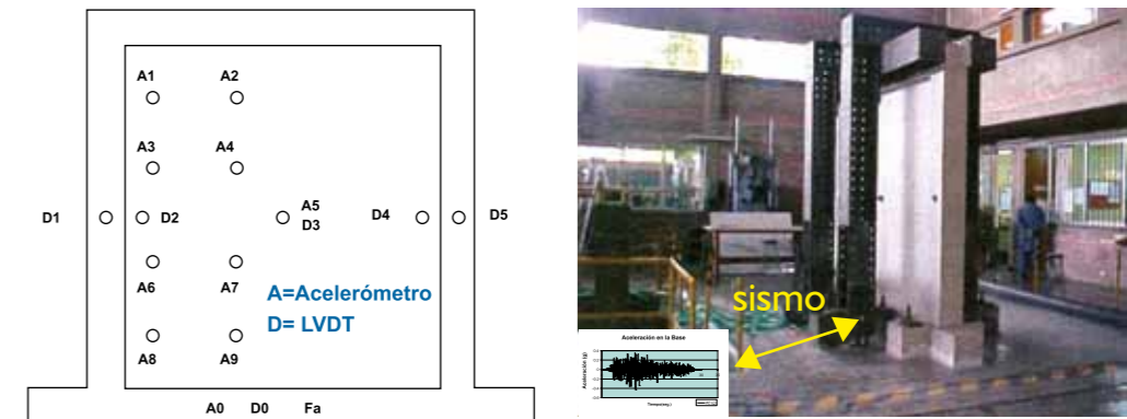
Fig.7. Instrumentación utilizada y vista global del ensayo sísmico.
